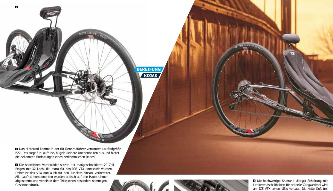
**I** Die mittig angeordnete obere Sitzbefestigung ist eine perfekte Kombination aus optimaler Kraftübertragung und Federungskomfort bei Fahrbahnunebenheiten. Fünf Rasterstufen ermöglichen einen Einstellbereich von 32° auf sagenhafte 25° Sitzneigung.
