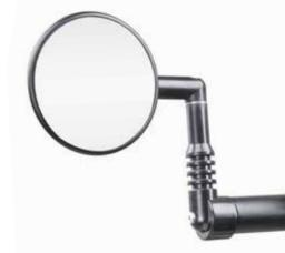
Der Mirrycle Mountain Spiegel wird am Lenkerende, oder wenn die Lenkerenden bereits zum Beispiel durch Lenkerendschalthebel belegt sind, an einem speziellen Spiegelhalter befestigt. Durch die verschraubte Bauweise lässt sich der Spiegel vertikal und horizontal verstellen und vibrationsarm verklemmen. Das konvexe Spiegelglas misst beachtliche 75 mm Durchmesser.
