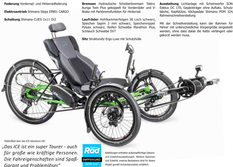
Ausstattung Lichtanlage mit Scheinwerfer SON Edelux DC 170, Gepäckträger ohne Aufsatz, Schutzbleche, Kopfstütze, Klickpedale Shimano PDM 324,
