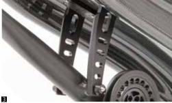
Lenkerendschalthebeln für schnelle Gangwechsel wird am ICE VTX serienmäßig verbaut. Die Kette läuft frei, damit die gesamte Muskelkraft auf das große Hinterrad übertragen wird. Die asymmetrisch montierten Kettenleitrollen laufen auf groß dimensionierten und zweifach gedichteten 6808 2RS Rillenkugellagern und stellen einen optimalen Kettenverlauf sowie möglichst geringen Verschleiß sicher.
